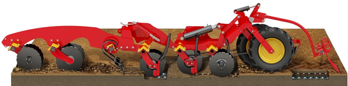
8 pav. Tiesioginės sėjamosios pagrindinės darbinės: 1) augalinių liekanų prispaudimo ratas, 2) trąšų įterpimo diskas, 3) sėklų įterpimo diskas, 4) sėklų prispaudimo ratukas dalys (Sky-agriculture, 2018).
