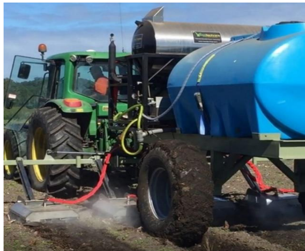
Piktžolių naikinimas ir dirvos dezinfekavimas vandens garų pagalba.
