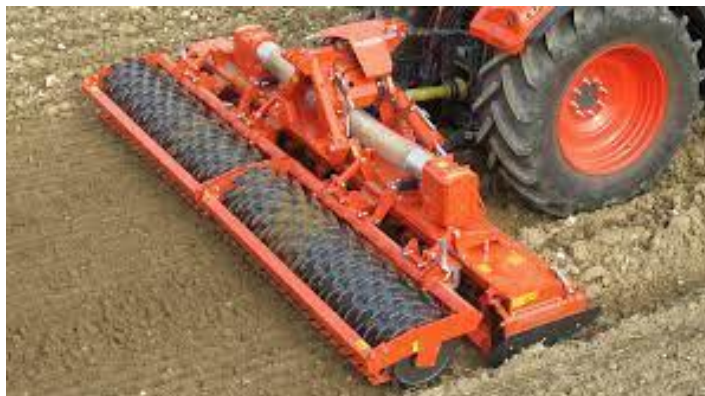
Rekomenduojama dirvos dirbimo technika daržininkystės ūkiams (rotacinė žemės freza su volu)
