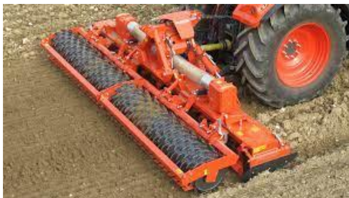
Rekomenduojama dirvos dirbimo technika daržininkystės ūkiams (rotacinė žemės freza su volu)
