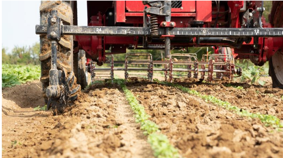
Precizinės mechaninės ravėjimo technikos agregatas–tarpueilių ravėtuvas
