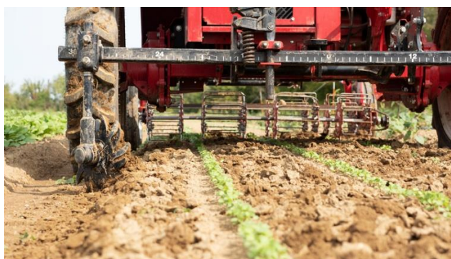
Precizinės mechaninės ravėjimo technikos agregatas–tarpueilių ravėtuvas
