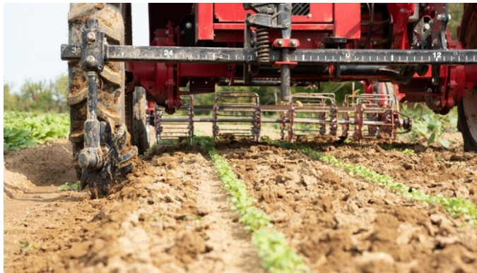
Precizinės mechaninės ravėjimo technikos agregatas–tarpueilių ravėtuvas
