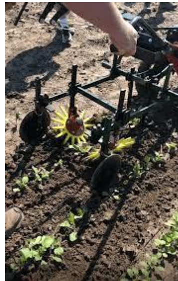
Precizinės mechaninės ravėjimo technikos agregatas–tarpueilių ravėtuvas
