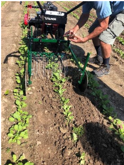
Precizinės mechaninės ravėjimo technikos agregatas–tarpueilių ravėtuvas
