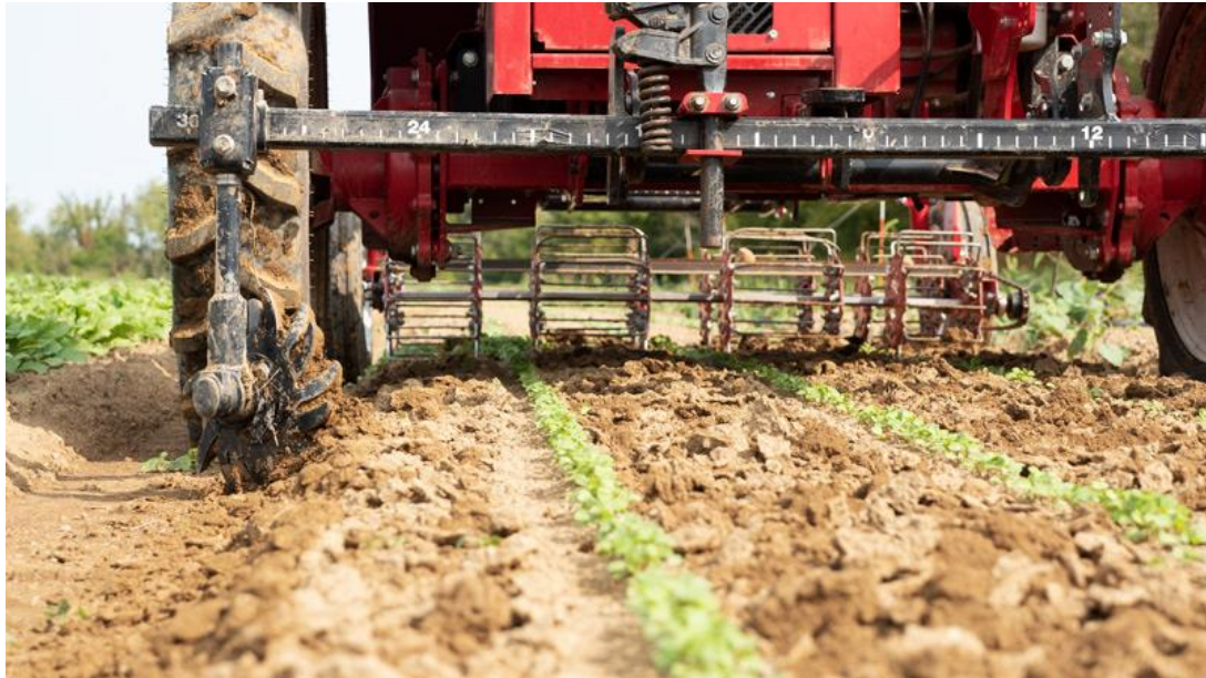
Precizinės mechaninės ravėjimo technikos agregatas–tarpueilių ravėtuvas
