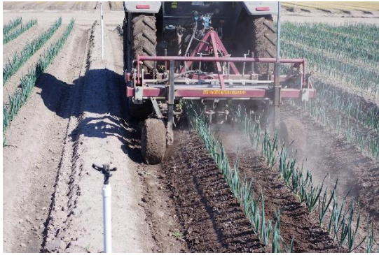
Precizinės mechaninės ravėjimo technikos agregatas–tarpueilių ravėtuvas
