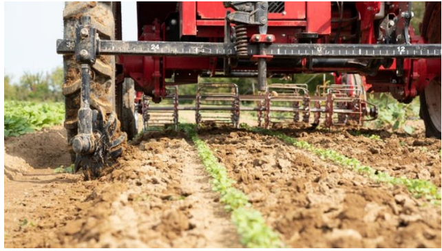
Precizinės mechaninės ravėjimo technikos agregatas–tarpueilių ravėtuvas
