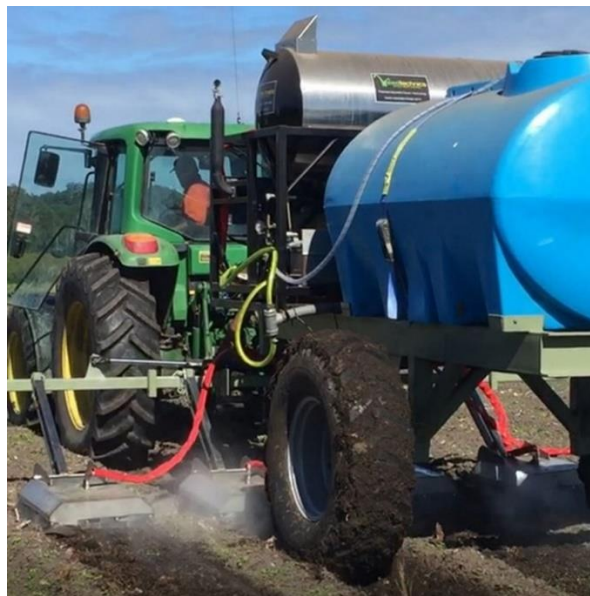
Piktžolių naikinimas ir dirvos dezinfekavimas vandens garų pagalba.
